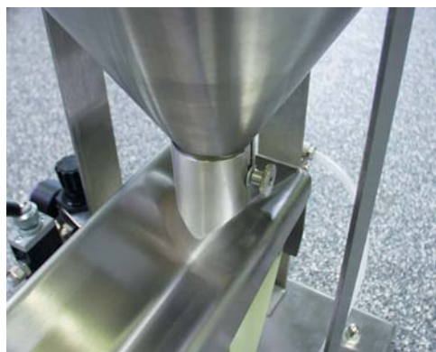
Regulowana długość końcówki wylotu zbiornika
