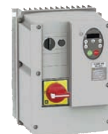
Przemienneki częstotliwości NFU montowane są w obudowie IP 54 przeznaczonej do montażu ściennego. Wyposażone są w wyłącznik główny, przełącznik kierunku obrotów oraz w potencjometr do ustawiania częstotliwości.
